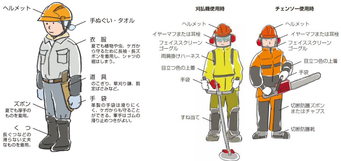
図 作業時の服装のイメージ(右は動力機械を使用する場合の服装のイメージ)
